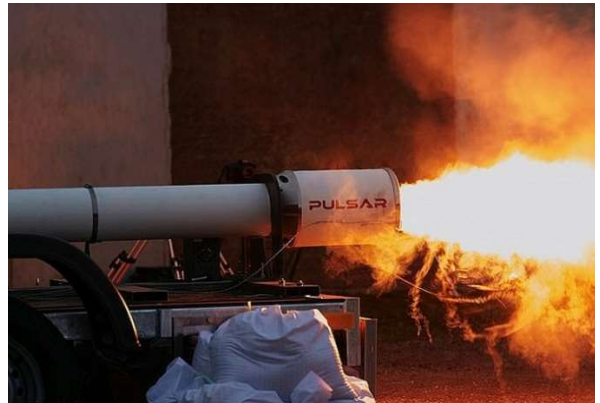
Động cơ chạy bằng rác thải nhựa của Pulsar khai hỏa thành công
