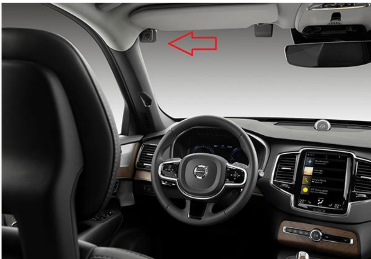
Hình 1: Camera và cảm biến được Volvo lắp đặt ngay phía trên tài xế.
